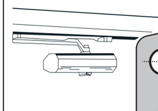
На рисунке установка производится на левостороннюю дверь.
