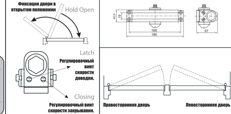
**Разметка для установки доводчика на левостороннюю дверь по принципу перпендикулярного рычага**
