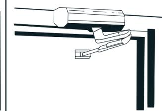
**Установка - параллельный рычаг**
